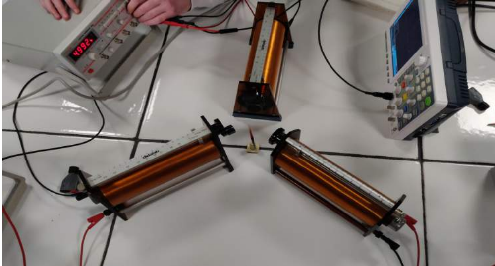
Montage expérimental où on y aperçoit un des trois GBF stabilisé à ~ 5Hz
