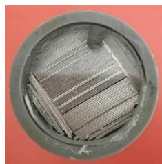
Observation transversale du noyau de fer
