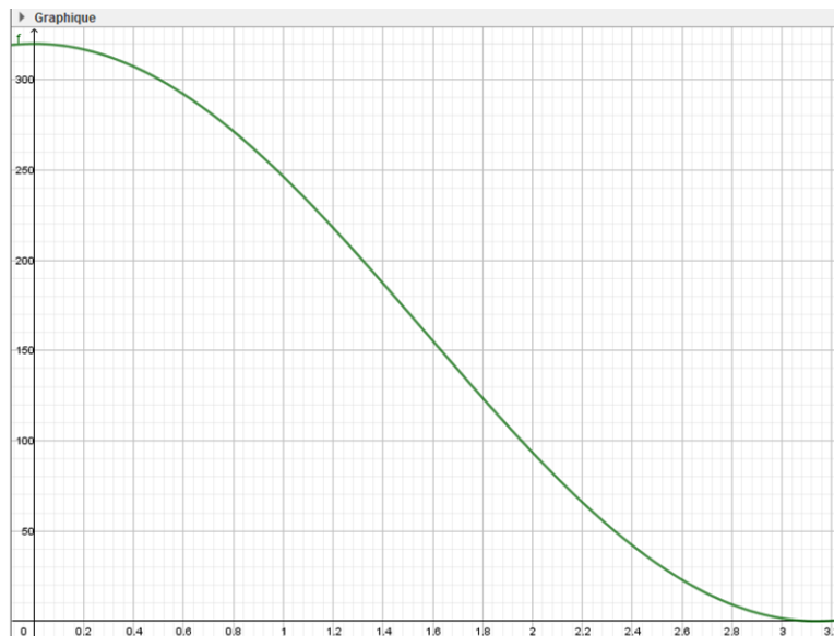
Figure 8 : Tension aux bornes de la photodiode suivant le déplacement du miroir
