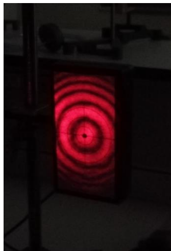
Figure 5 : Figure d'interférence (obtenue avec une configuration en lame d'air) projetée sur notre photodiode
