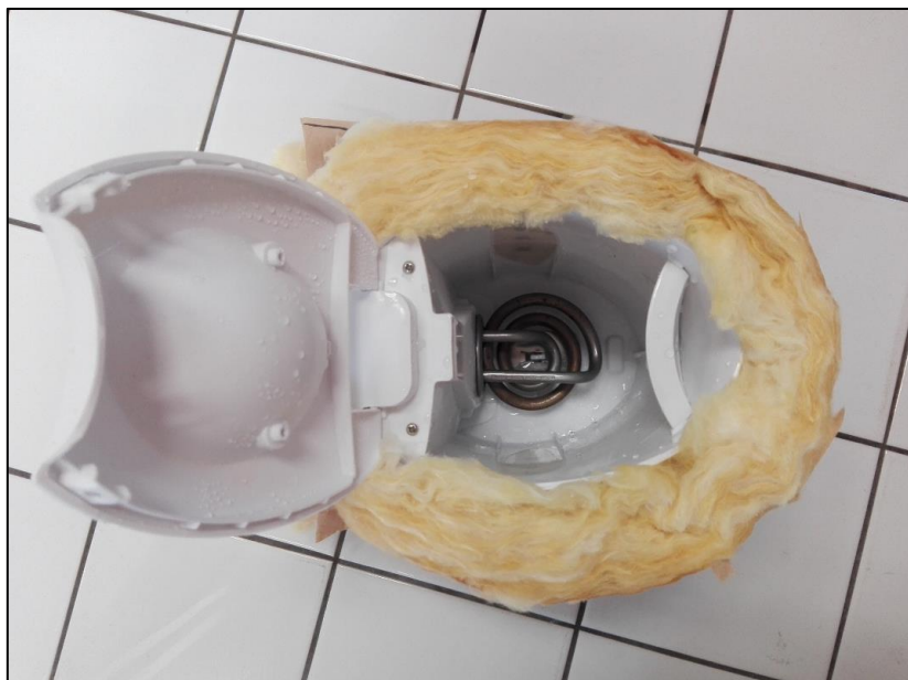
Bouilloire vue de dessus. On distingue la résistance chauffante et la couche d'isolation thermique.
