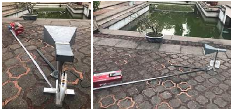
FIGURE 5 – Montage expérimental de la caractérisation de la puissance de l'onde sortie de l'antenne cornet en fonction de l'angle de propagation et de la distance par rapport à la source
