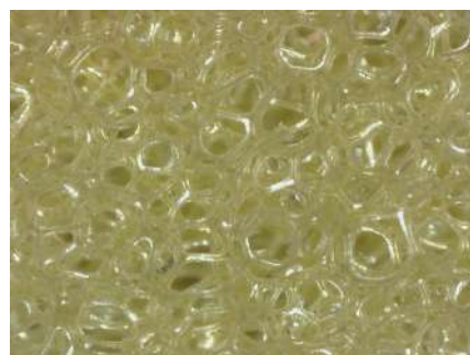
Image 2: mousse 35 observée au microscope USB sans contrainte
