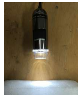
Montage d’observation des mousses au microscope USB
