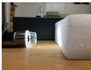
Montage d’observation des mousses au microscope USB
