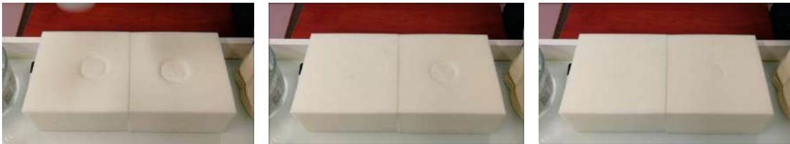
Photos de mousses mémoire de forme à température ambiante (mousse de gauche) et refroidie (mousse de droite) après avoir appliqué une masse pour observer la vitesse de reformation
