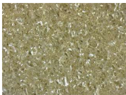
Images 1.a) et 1.b) : mousse 35F au microscope USB sans contrainte (a) puis compressée (b)
