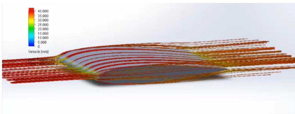
Simulation SolidWorks de l'écoulement de l'air sur un profil d'aile réalisée par Benjamin Boyries
