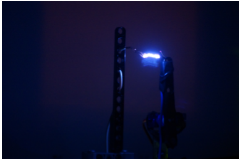
Figure 6: Photo d'un arc électrique avec une majorité d'Argon en composition atmosphérique
