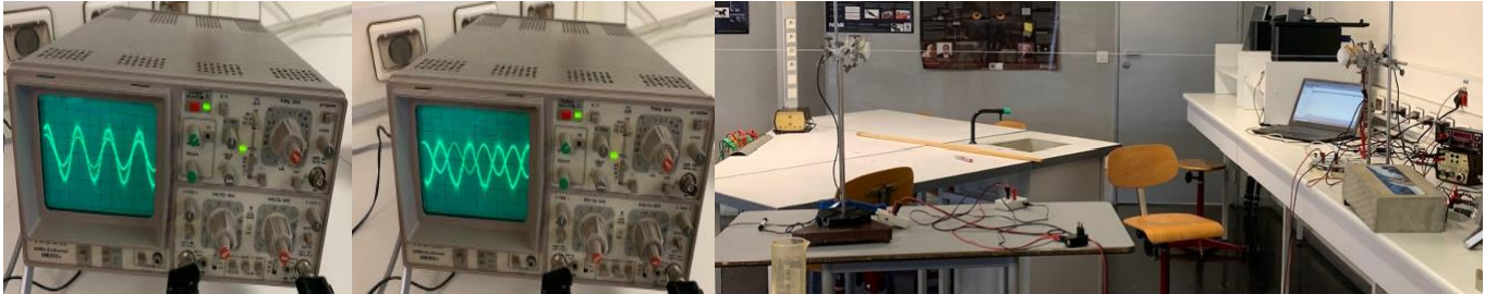
figure 11 : A gauche : signal du pot 3 en phase avec l'émetteur – Au milieu, signal du pot 3 en opposition de phase avec le signal émetteur. A droite, dispositif expérimental avec table mobile portant le pot 3
